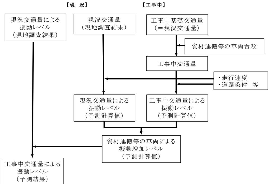
図 10.3.2-3 資材運搬等の車両の走行に伴う振動の予測手順
