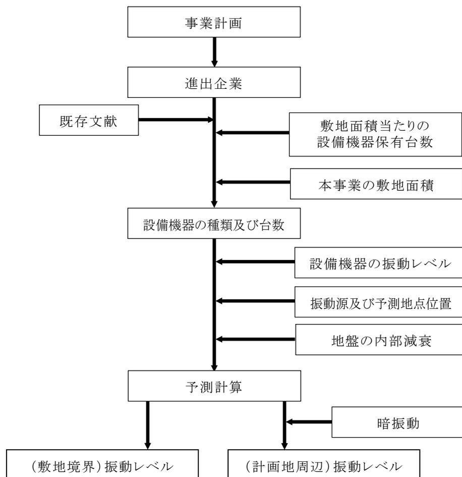
図 10.3.2-5 施設の稼働に伴う振動の予測手順
